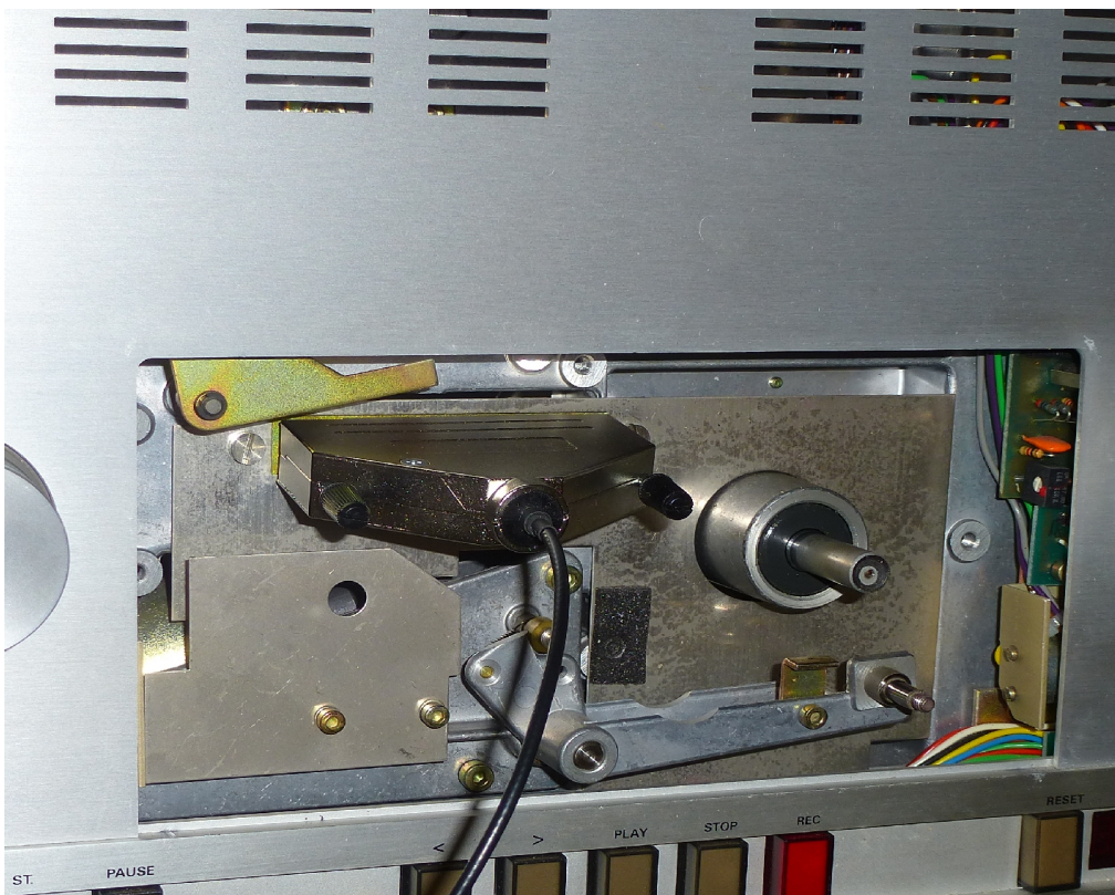
B67 mit Omega-Einspeise-Stecker am Kopfträger -Stecker
