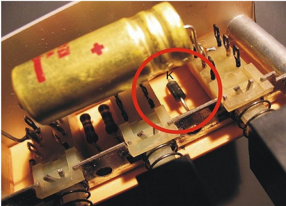
Diese Schottky-Diode wird auf der Platine aufgelötet, Polarität beachten!
