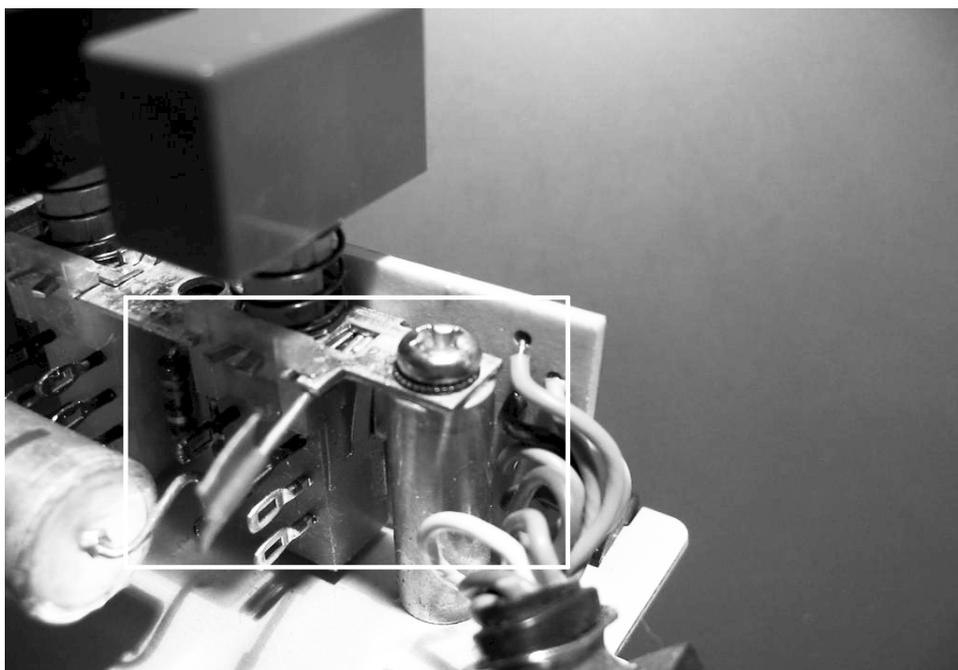
Die Diode im Kreis wird polaritätsgleich durch die Schottky-Diode ersetzt
