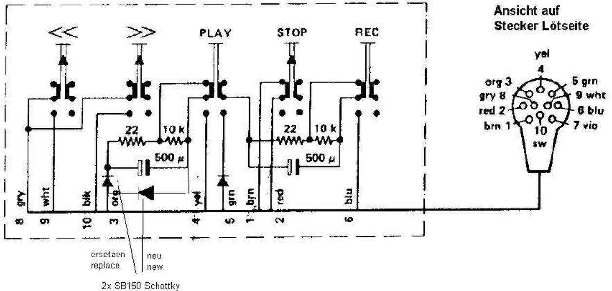
Bei der Gelegenheit kann man auch den Rast-Mechanismus der Play - und Record Taste deaktivieren, z.B. indem man einen kurzen Draht hier einsteckt.
