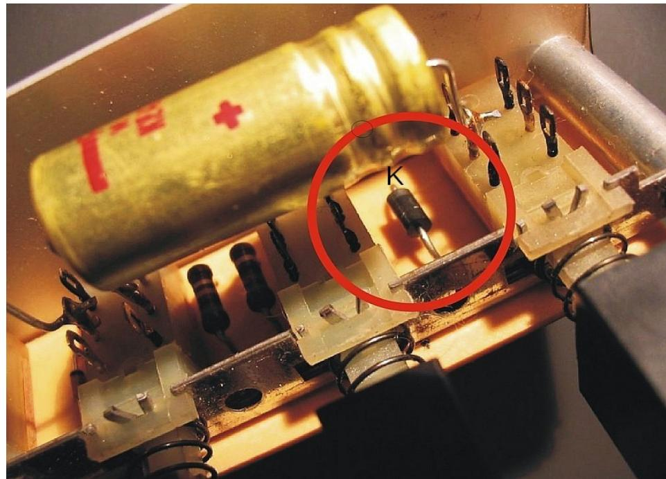
Diese zweite Schottky Diode wird auf der Lötseite der Platine aufgelötet.
