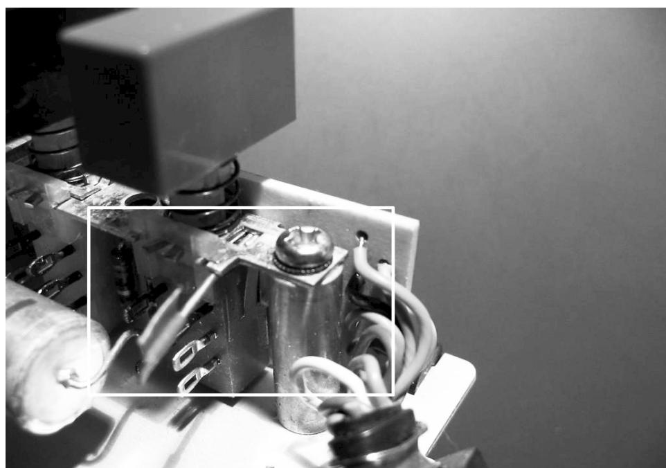
Diese Diode im Kreis wird ersetzt durch die Schottky-Diode
