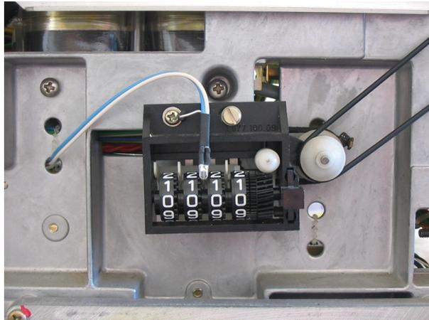
6. Kabel durch die Öffnung der Aluplatte führen.
