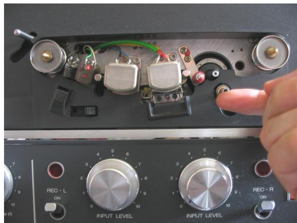
4. die Kreuzschlitzschraube des Zählwerks entfernen und die Halterung der LED damit befestigen.
