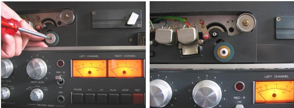
2. Kreuzschlitzschrauben an der Frontblende ausschrauben - Beim Wiederaufbau diese Schrauben nur moderat anziehen, nicht bis der Kunststoff ( 25 Jahre alt) bricht !!
