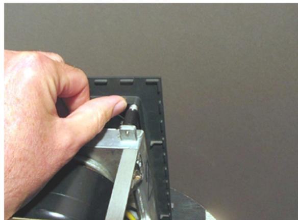
Die oberen Befestigungspunkte sind 3 Rastverschlüsse
