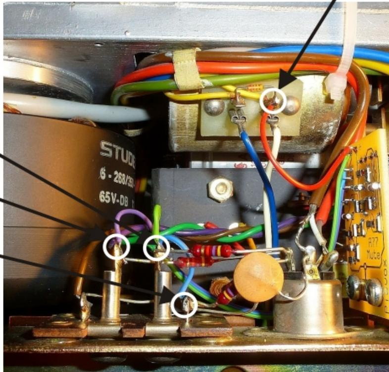
Damit man unten an den Transistor-Pin besser herankommt, die Leitungen zum Bremsmagnet abstecken, nachdem man die Position der blauen Leitung markiert hat.
