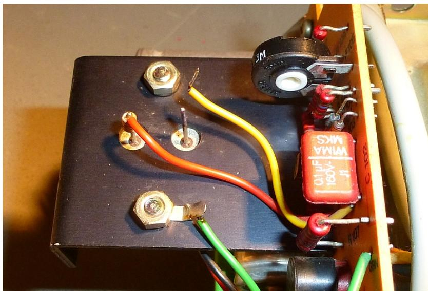
Das verzinnte Ende der Litze in die Aderendhülse einführen, auf den Transistor-Pin schieben und anlöten mit etwas Lötzinn.
