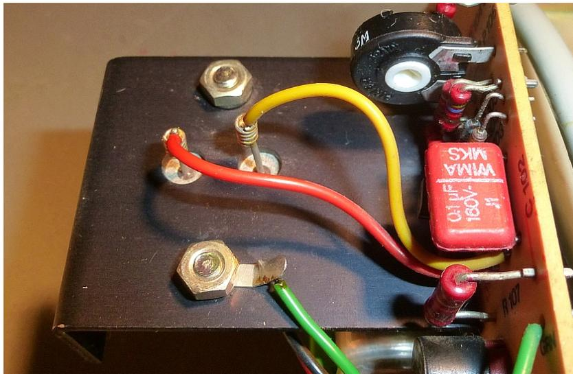
Die gelbe Litze am Transistor-Pin ablöten und Lötstelle säubern / absaugen
