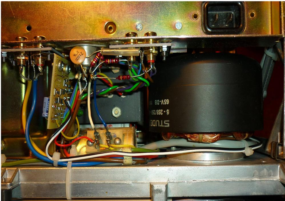
Zwei kleine Lötunkte sind an der A77\_Mute Platine auszuführen
